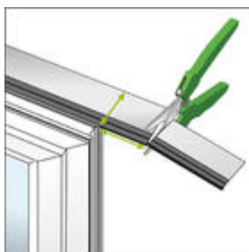
Afb. 10 De folie met ca. 5 cm overlengte afknippen.
